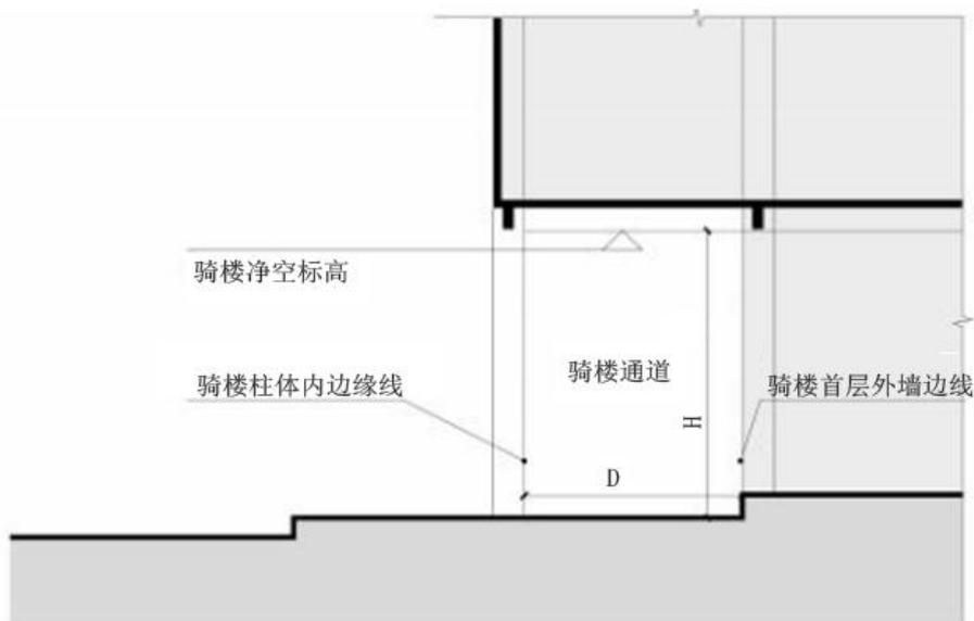
骑楼通道最窄处净宽 $D \geq 3.0$ 米, 净高 $H \geq 4.5$ 米。
