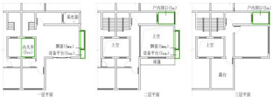
$S_k$  为本套住宅飘窗、设备平台、结构连板、户内凹口、户内洞口、内天井的投影面积之和
